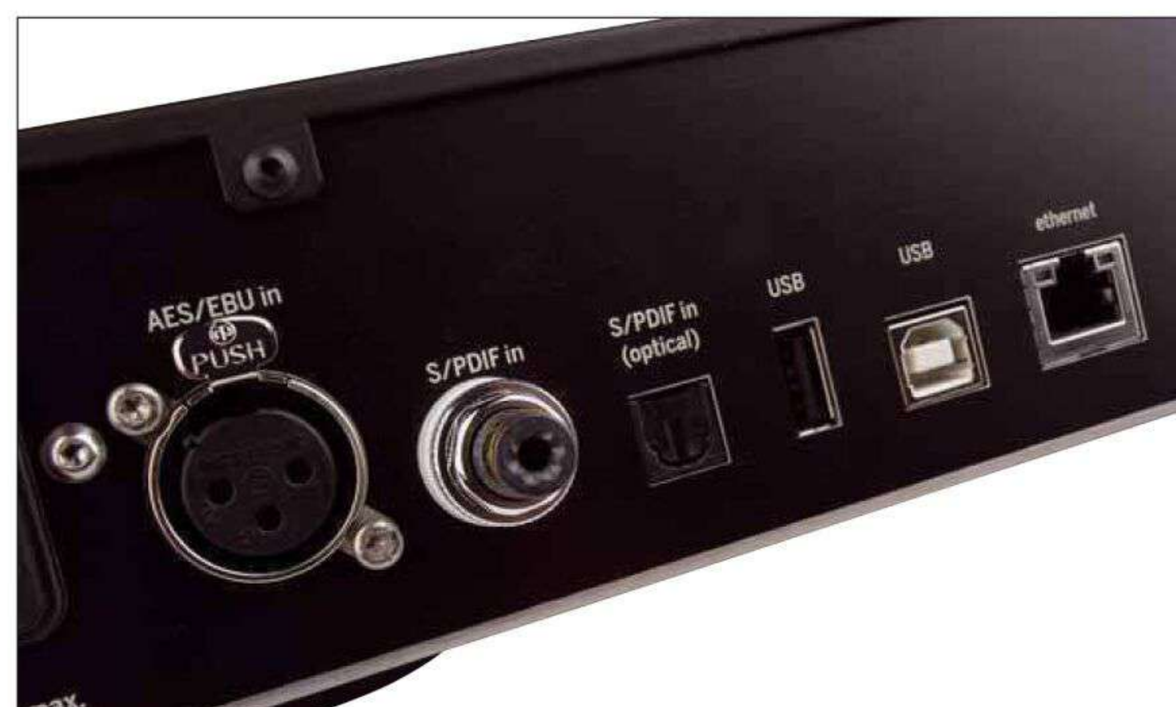
Auch externe Quellen können dank verschiedener Digitaleingänge vom Signal-Processing profitieren
